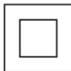
Apparecchio con isolamento elettrico di classe II
