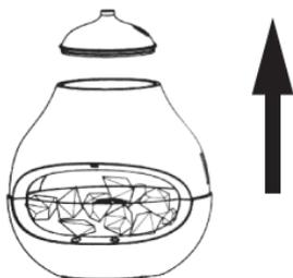
3. Utilizzare il misurino per versare una quantità d'acqua sufficiente nel serbatoio. **NON** versare acqua oltre il segno di livello MAX sul serbatoio dell'acqua. Il diffusore non funzionerà se riempito oltre il segno di livello MAX.
