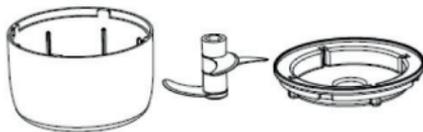
2. Fissare la lama nel contenitore, inserire piccoli pezzi di cibo e coprire con il coperchio isolante.
