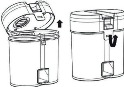
Per prima cosa, rimuovere il filtro in acciaio inox e il filtro HEPA dal contenitore. Entrambi i filtri devono essere lavati con acqua corrente, evitando l'uso di detergenti o spugne abrasive.
