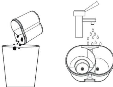
Le parti interne devono essere pulite separatamente. Lavare ciascun componente con acqua e lasciarlo asciugare completamente prima del rimontaggio.
